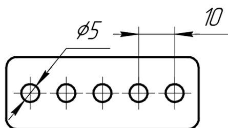
Схема расположения монтажных креплений
